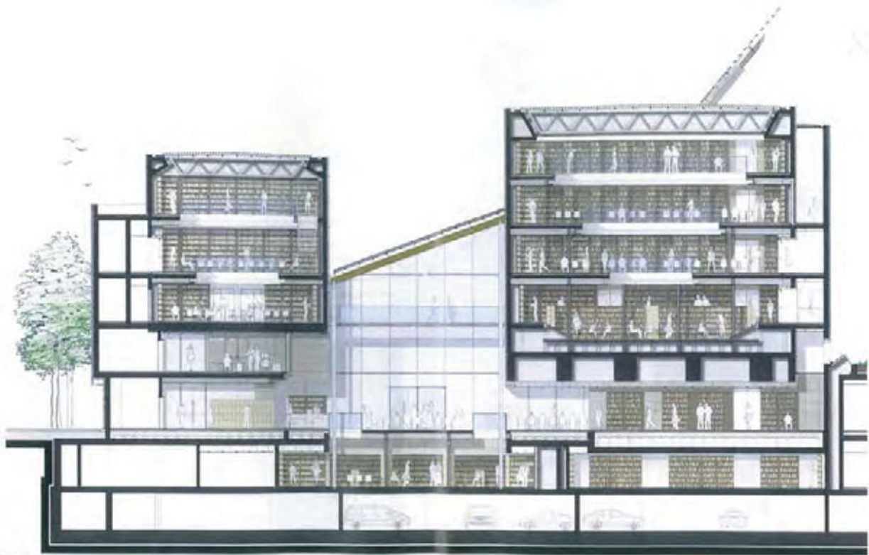
Fig. 4 La sezione mostra la successione est-ovest dei volumi che costituiscono la nuova Biblioteca Universitaria. Partendo da sinistra il volume III è caratterizzato da un corpo sospeso rivestito in pietra. Al centro il volume della grande lobby mette in comunicazione visiva sia trasversalmente che verticalmente l'intero complesso. A destra III è caratterizzata anch'essa come un corpo sospeso in pietra alta circa 25 mt. contenente la sala principale. All'interno dei due volumi cubici gli ampi ballatoi decorano progressivamente salendo dando modo alla luce di filtrare. I due corpi sono collegati in quota da una passerella panoramica.
